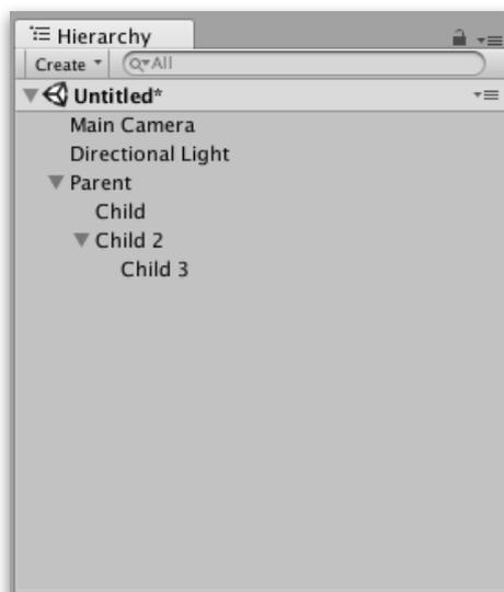
點擊父物件的下拉箭頭（在其名稱的左側）顯示或隱藏其子項。按住 Alt 鍵同時點擊下拉箭頭以切換父項的所有子物件的顯示或隱藏。
